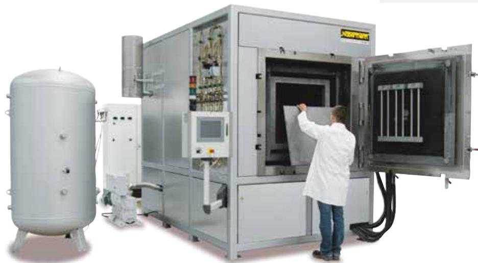
Пайка твердым припоем в газационном коробе
