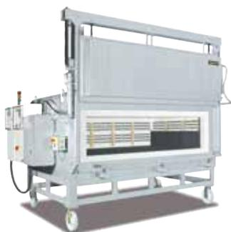
Печь для отжига, оборудованная подъемной дверью с электрогидравлическим механизмом и передвижной опорной рамой для предварительного нагрева крупных деталей из листового металла в автомобильной промышленности см. страницу 44
