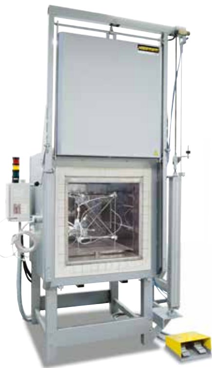
Измерительная рама для определения однородности температуры
