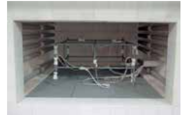
Измерительное устройство в печи для отжига
