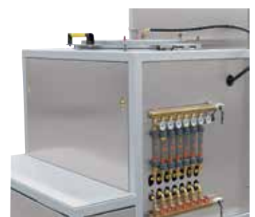
Система регулирования водяного охлаждения
