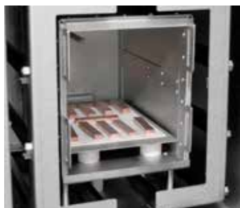
Тепловая обработка медных стержней в водороде в печи VHT 08/16 MO
