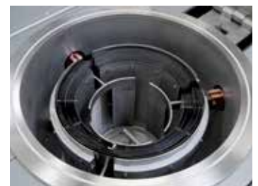
Цилиндрическая реторта с вольфрамовым нагревом
