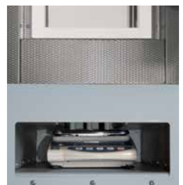
HT 16/17SW со взвешивающим устройством для определения потерь при прокаливании
