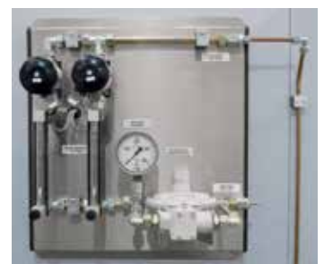
Газационная система для негорючего защитного или реакционного газа
