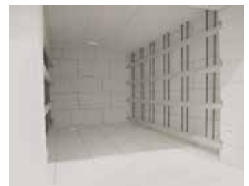
Защитная решетка перед нагревательными элементами для защиты от механических повреждений
