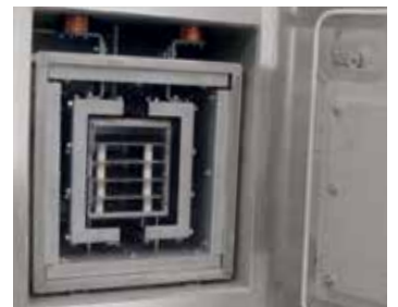
Молибденовый нагревательный элемент
