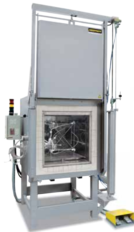
Измерительная рама для определения однородности температуры
