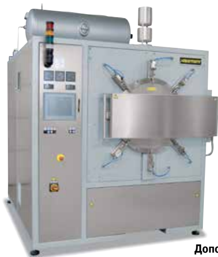
NR 200/11 H 2 для тепловой обработки под водородом
