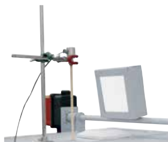
Заслонка отводимого воздуха и термоэлемент загрузки со штативом в качестве дополнительного оборудования
