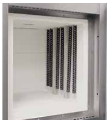
Стержневые нагреватели с вертикальной подвеской
