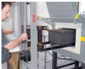
Работа в ящике подачи газа для атмосферы защитного газа с помощью грузочной тележки
