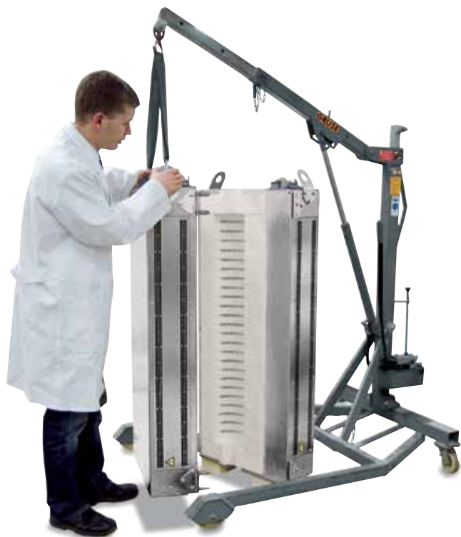
RS 120/1000/11S в двухсекционном исполнении. Обе полупечи имеют идентичное исполнение и для экономии места интегрируются в установку заказчика для подогрева газа.
