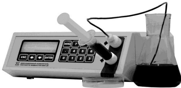
Рисунок 18 — «Обратный» ввод пробы
