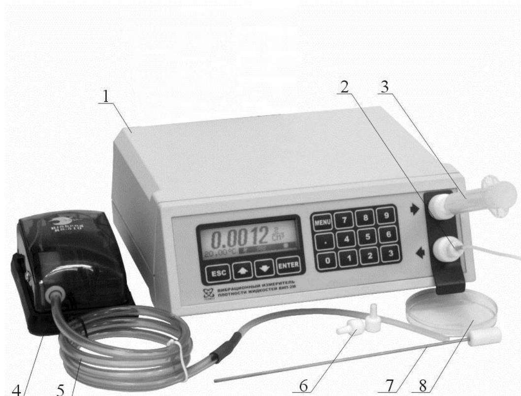
Рисунок 1 — Плотномер ВИП-2МР с принадлежностями
