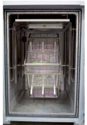
Печь для отжига силикона с герметично сваренным внутренним коробом и поворотной тележкой для загрузки
