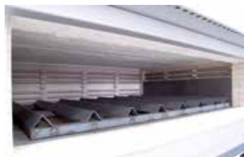
N 1760/S для предварительного нагрева листов с подставкой для загружаемого материала
