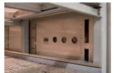
Вводы для подключения вакуум-провода и измерительной линии в камерной печи с циркуляцией воздуха
