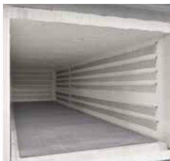
Волокнистая изоляция и меандровые нагревательные элементы для коротких времен процесса
