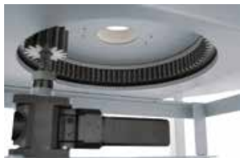
Шестеренчатый привод под подом печи
