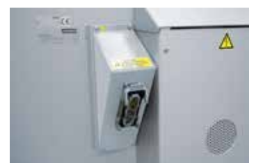
Штекерный разъем на печи для подключения кабеля к распределительному и регулиющему устройствам
