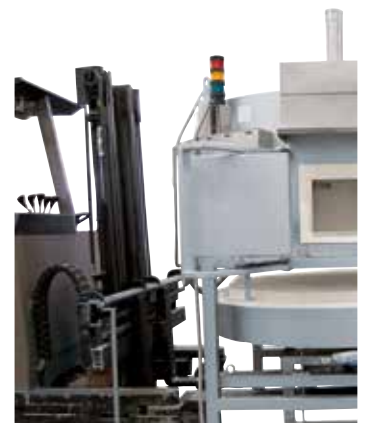
Под печи для выполнения технического обслуживания может опускаться
