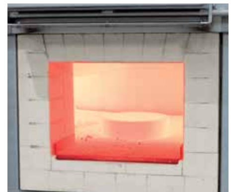
Предварительный нагрев стальных колец дляковки
