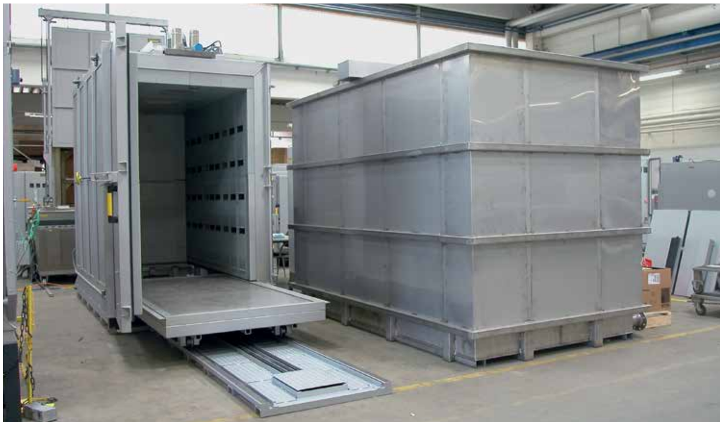
Печь с выдвижным подом W 7440/26 AS для диффузионного отжига и водяная баня WB 24000/S для закалки
