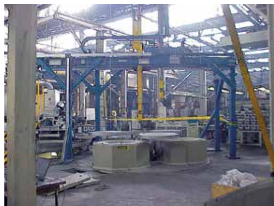
Установка с поворотным столом с 3 печами Т 150/11
