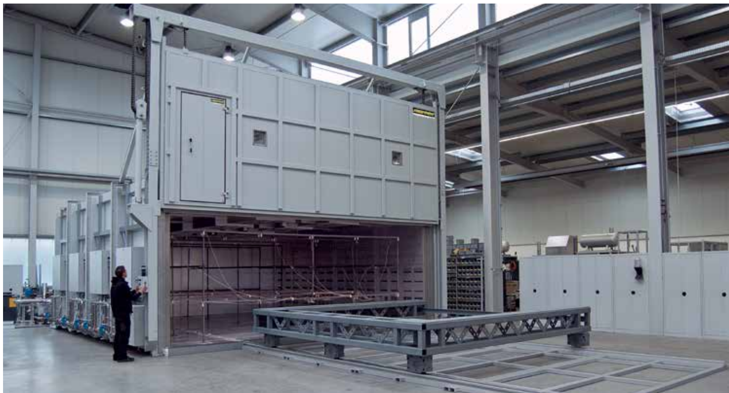
Камерная печь с циркуляцией воздуха N140000/26AS для затвердевания многослойных волокнистых материалов в вакуумных мешках, вкл. насос и необходимые соединения в пространстве печи
