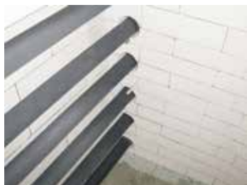
Обогрев с двух сторон при помощи мощных стержневых нагревателей из карбида кремния
