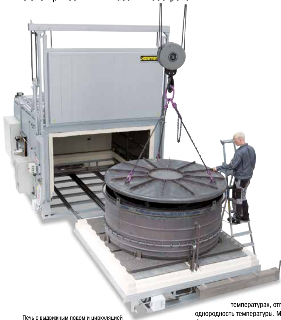
Печь с выдвижным подом и циркуляцией воздуха W 5290/85AS с газационной камерой для термообработки рулонного материала в среде защитного газа
