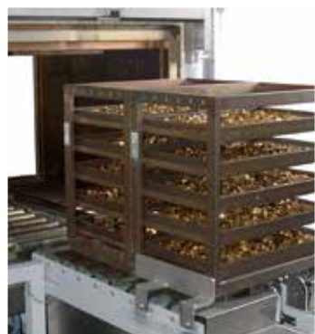
Проходная печь для термообработки клепок
