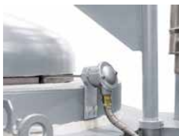
Термоэлемент для системы управления ванной с расплавом
