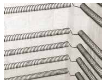
Изоляция боковых стенок волокнистым материалом в печах модели TF
