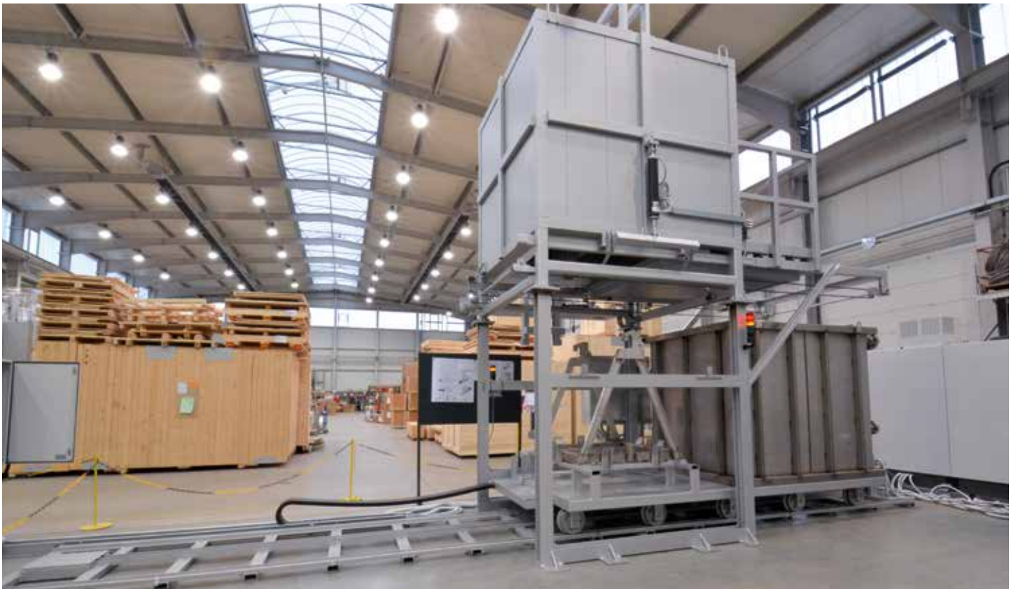
Линия термообработки для алюминия с шахтной печью FS 2200/60AS и закалочной ванной
