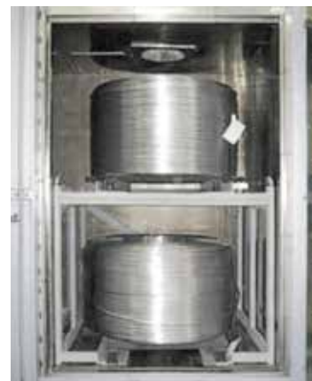
Передача тепла от теплой партии изделий холодной партии
