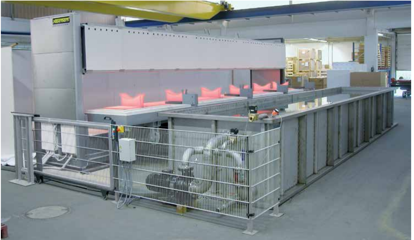
Установка, оснащенная сводчатой печью H 4263/12S и водяной баней
