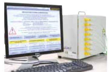
Интерфейс системы управления Control-Center NCC на базе ПК
