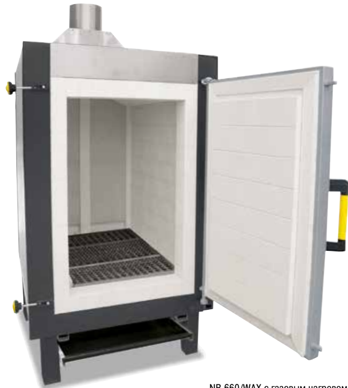
NB 660/WAX с газовым нагревом
