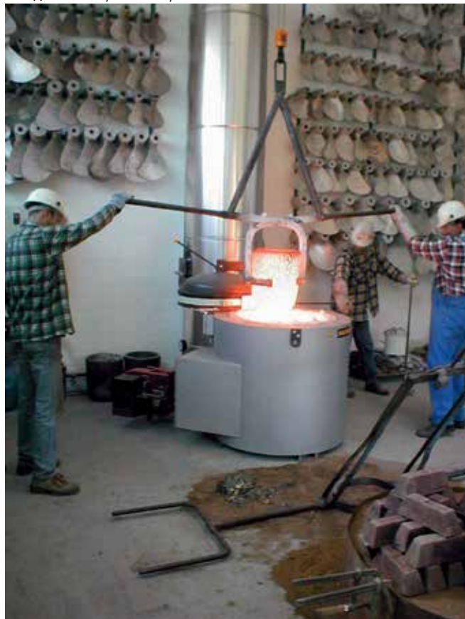
ТВ 40/14 с оборудованием для вытягивания тигля
