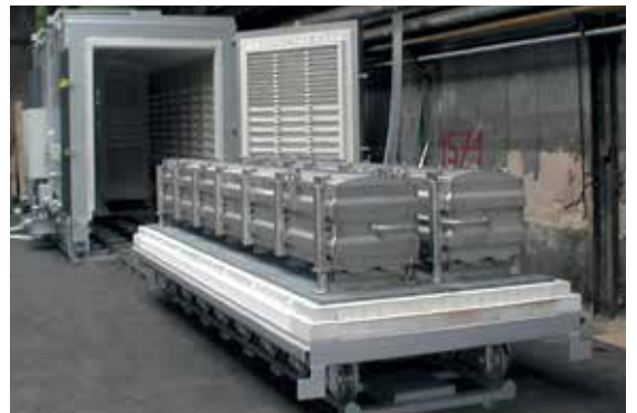
Печь с выдвижным подом и газационной системой
