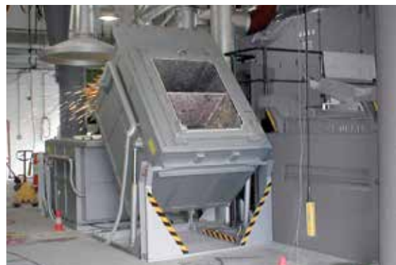
Наклоняемая плавильная печь для магния К 1500/75 S с тиглем вместимостью 1500 л
