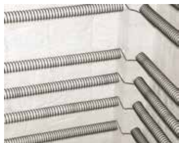
Изоляция боковых стенок волокнистым материалом в печах модели KF
