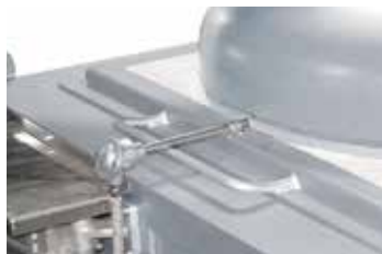
Система управления ванной с расплавом с термоэлементом в расплаве.
