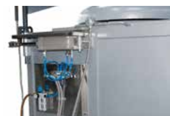
Пневматическое устройство открытия крышки
