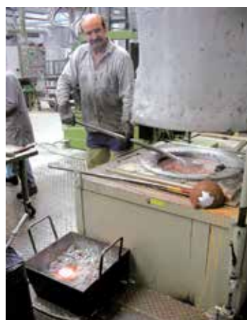
Ручное вычерпывание расплава из печи Т 80/11
