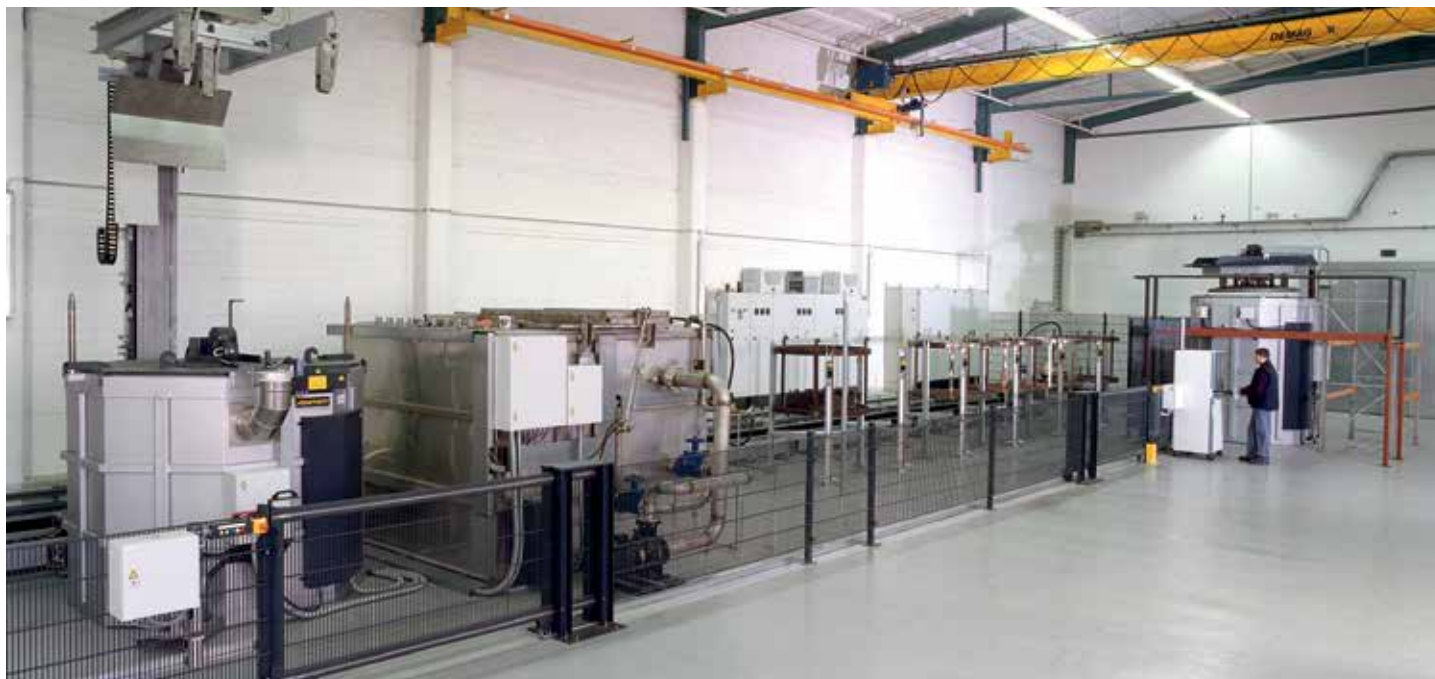
Полностью автоматическая установка для улучшения алюминия, оборудованная 2 шахтными печами, водяной баней и 6 полками для хранения изделий
