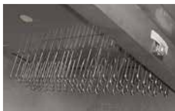
Нагревательный регистр при исполнении с электрическим обогревом
