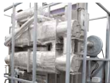
Противоточный теплообменник в камерной печи с циркуляцией воздуха N 2560/26 ACLS
