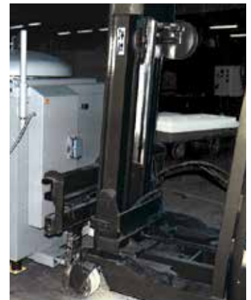
Крепление для вилочного автопогрузчика под печью
