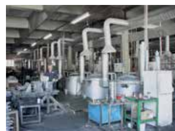
Рекуперативные горелки в плавильной печи для алюминия 16 x TBR 110/12 и 2 x TBR 180/12
