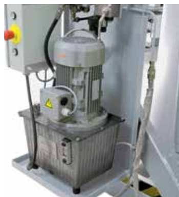
Гидравлический агрегат с трудно воспламеняющейся гидравлической жидкостью
