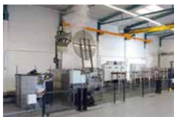
Выемка загрузочной корзины из печи для диффузионного отжига и перемещение в водяную баню
