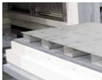
Подставка для загружаемого материала в печи с выдвижным подом на 850 °C
