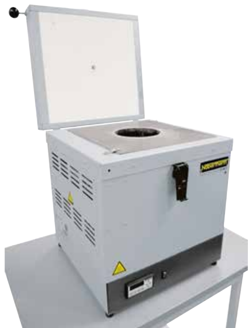
К 2/10 в качестве стационарной тигельной печи с ручным вычерпыванием расплава со стальным тигелем для плавения свинца
