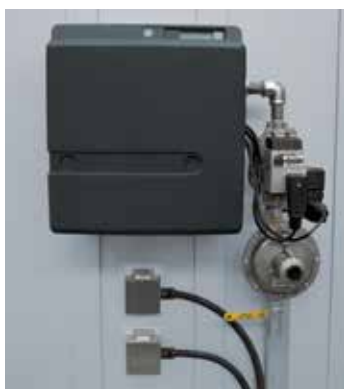
Компактная горелка для стандартных моделей до NB 600
