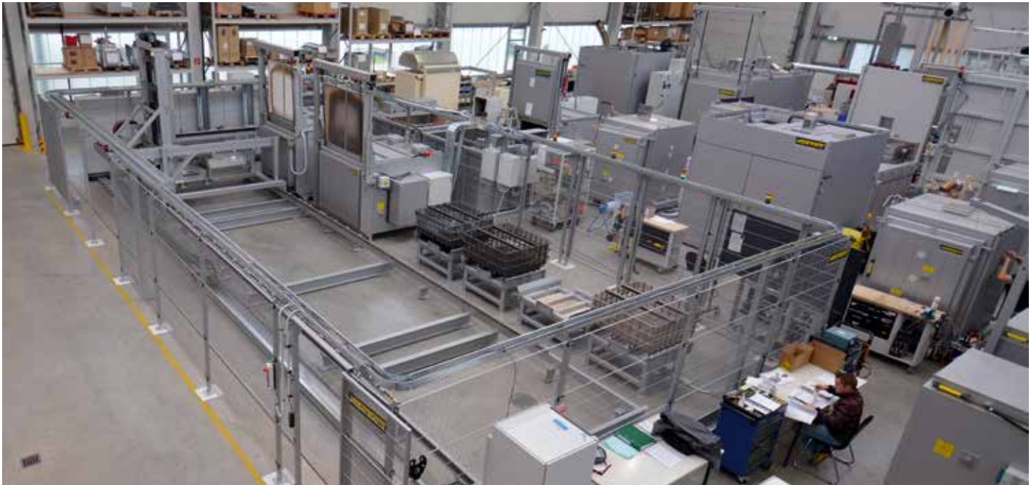
Автоматическая линия термообработки с двумя камерными печами, закалочной ванной, транспортным оборудованием и плацами для четырех загрузочных коробов
