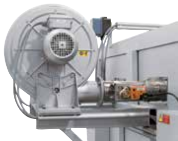
Охлаждающий вентилятор для ускоренного охлаждения
