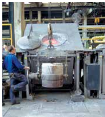
Заполнение транспортировочного литейного ковша с помощью печи К 360/12
