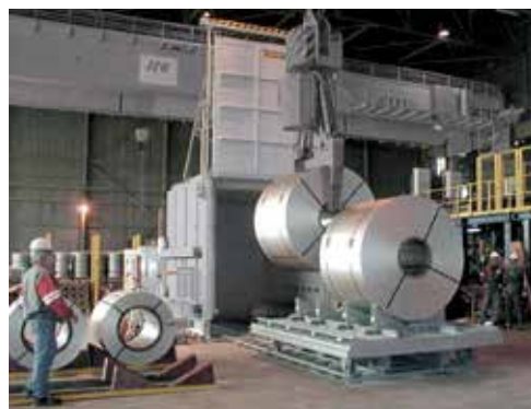
Печь с выдвижным подом для тепловой обработки рулонов
