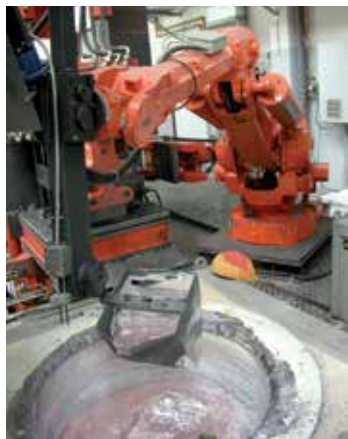
Извлечение расплава из печи Т 650/10 с помощью робота для вычерпывания расплава
