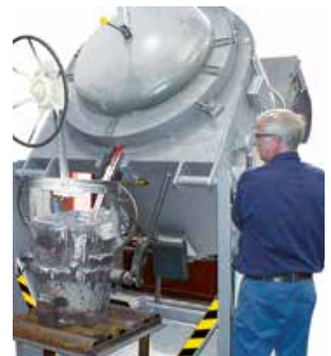
KB 240/12 для плавления алюминиевых сплавов
