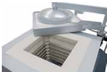
Плита с бортиком электрической тигельной печи, отводимая в сторону для вытягивания тигля
