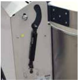
Интегрированные газонаполненные амортизаторы облегчают открывание и закрывание крышки печи. Без каких-либо затруднений можно открыть даже большие модели.
