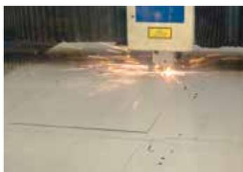
Чтобы обеспечить будущее предприятию в Германии, мы используем для производства наших печей самые современные машины. Все листовые детали печей точно нарезаются на станке для лазерной резки.
