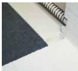
Просто снимаемая плита основания из карбида кремния для защиты нагрева дна и удобной очистки пода печи. Нагревательные элементы легко заменяются.
