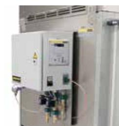
Автоматическое выполнение программ при помощи контроллера
