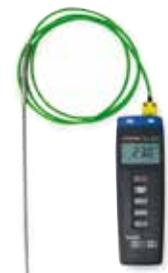
Термометр для RAKU 100, простой в обслуживании, температурный датчик NiCr-Ni, диапазон индикации 20 - 1200 °C, возможность подключения второго датчика с функцией переключения индикации
