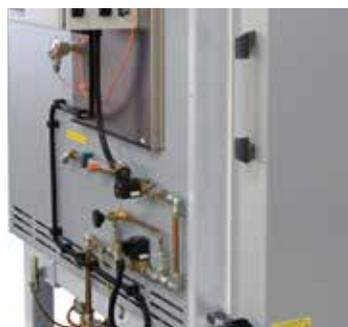
Газовое оборудование и термоэлемент в печи
