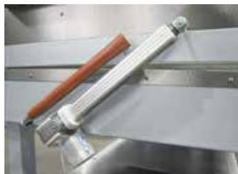
Открытие колпака при помощи двигателя посредством электромеханического шпинделя
