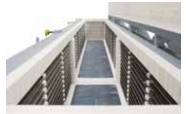
Пространство печи модели S 5120/GS с установленной теплоизоляционной плитой для разделения пространства печи на две части
