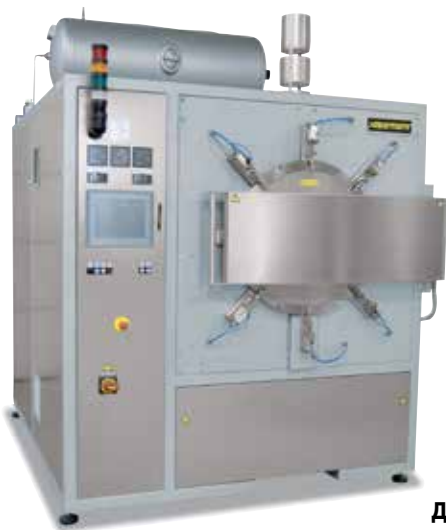
NR 200/11 H 2 для тепловой обработки под водородом
