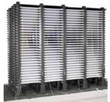
Загрузочная установка для мелких керамических деталей
