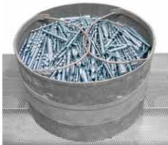
Воронение сверл водяным паром в печи серии NRA
