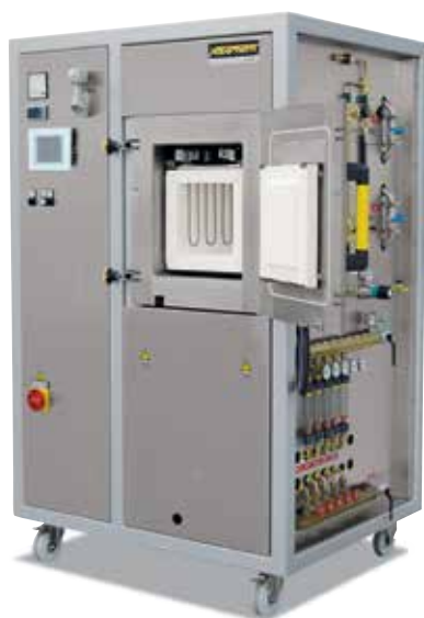
VHT 8/18-KE с волокнистой изоляцией и нагревательными элементами из дисилицида молибдена
