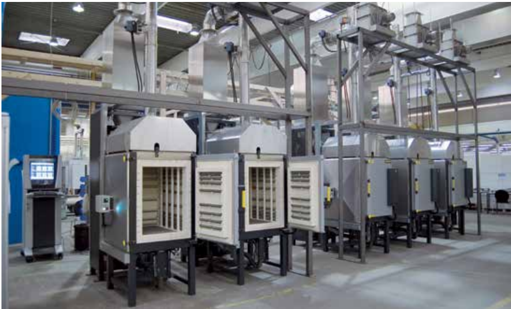
Промышленная установка, состоящая из пяти комбинированных камерных печей N 300/HDB с комплектом для выжигания II и системой каталитического дожигания
