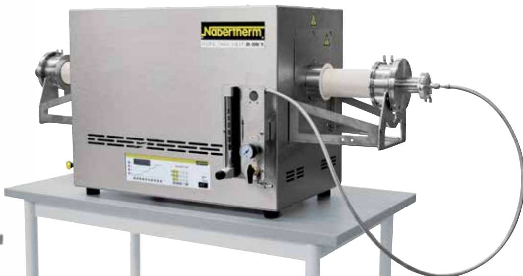
RHTC 80-450/15 с ручной системой подачи газа
