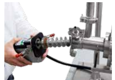
Шнековый транспортер с регулировкой скорости вращения
