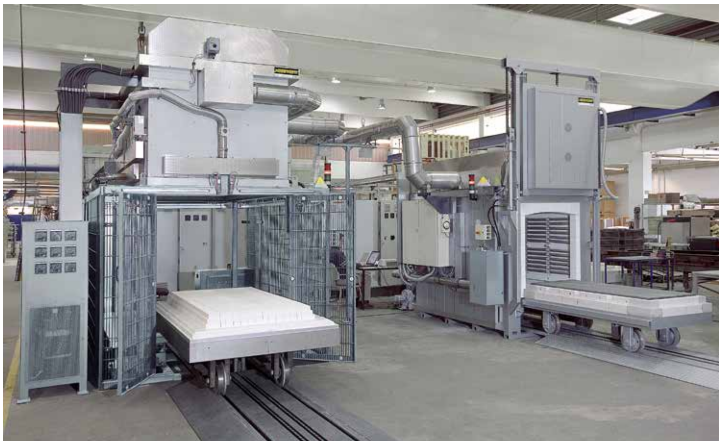
Производственная установка, состоящая из печи с выдвигаемым подом для выжигания и высокотемпературной печи для дополнительного выжигания и спекания и с общей установкой каталитического дожигания
