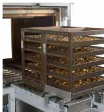
Проходная печь для термообработки клепок
