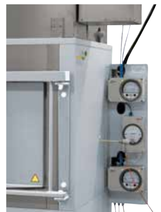
Индикатор давления и объемных потоков, входящий в комплектацию II
