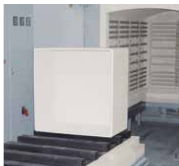
Печь с выдвижным подом W 3300 для глазирования плавильных тиглей в соляризации
