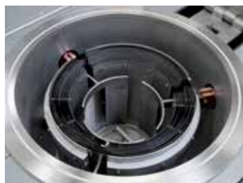
Цилиндрическая реторта с вольфрамовым нагревом
