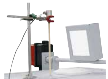
Заслонка отводимого воздуха и термоэлемент загрузки со штативом в качестве дополнительного оборудования
