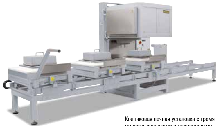
Установка с элеваторным механизмом для верхней крышки H 245/LTS с охлаждающей установкой и установкой для смены столов
